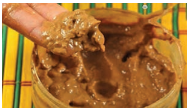
شکل ۵۵- بنتونیت آب جذب کرده و متورم شده
